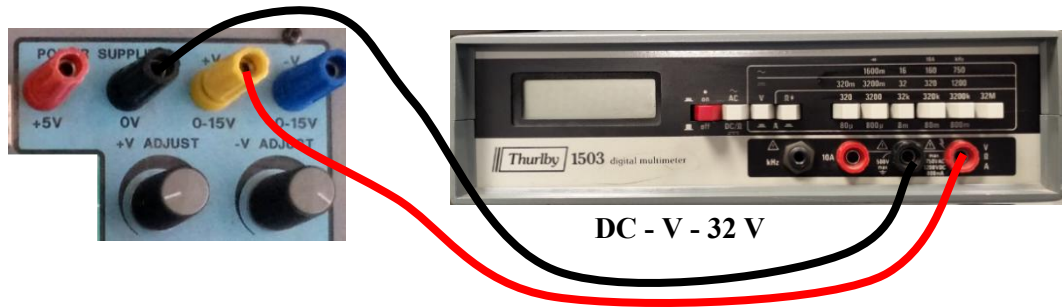
Şekil I.3.2. Güç kaynağı ile DC voltaj ayarlama bağlantısı
