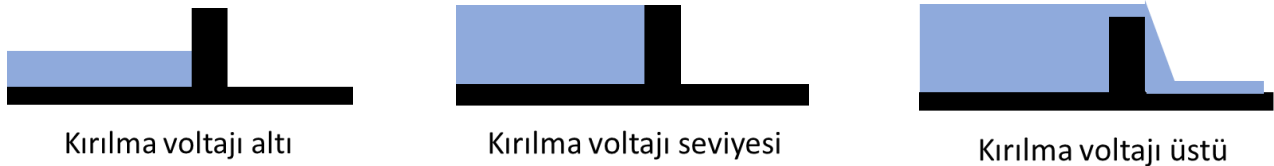
Şekil II.13.2. Barajın suyu tutma aşamalarının zener diyotun kırılma voltajı ile benzerliği
