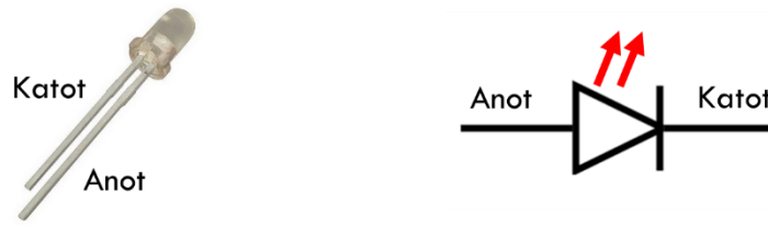
Şekil II.16.1. LED'in fotoğrafı ve devre sembolü
