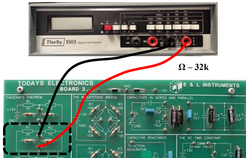
Şekil II.2.7. V_{th} çıkartılarak kısa devre yapılması
